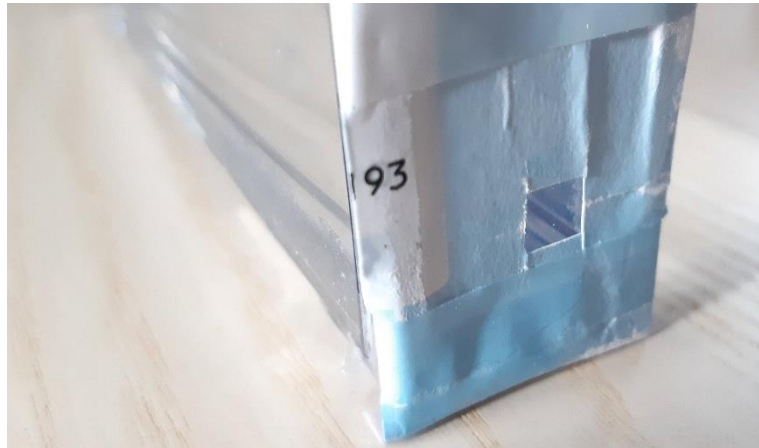
Rysunek 2. Przesłona z papieru umieszczona na tylnej ścianie pojemnika.
